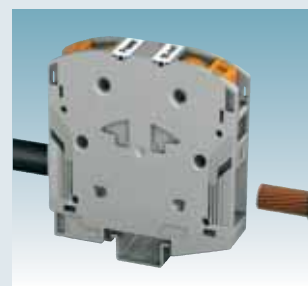
Svornice PTPower s přímým Push-in připojením, k průřezu max. 150 mm 2
